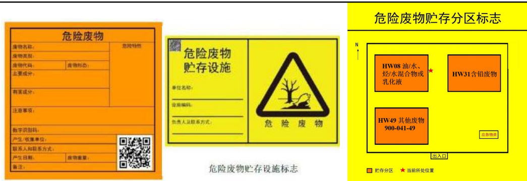
图 5-1 危险废物、贮存设施及分区标志
