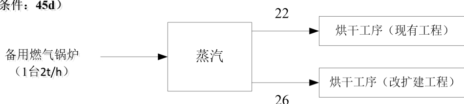
图4 全厂蒸汽平衡 单位: t/d
