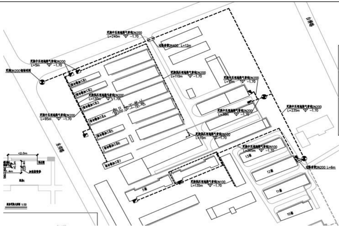
图 4.1.2.1-1 东盛小区中压埋地管网图
