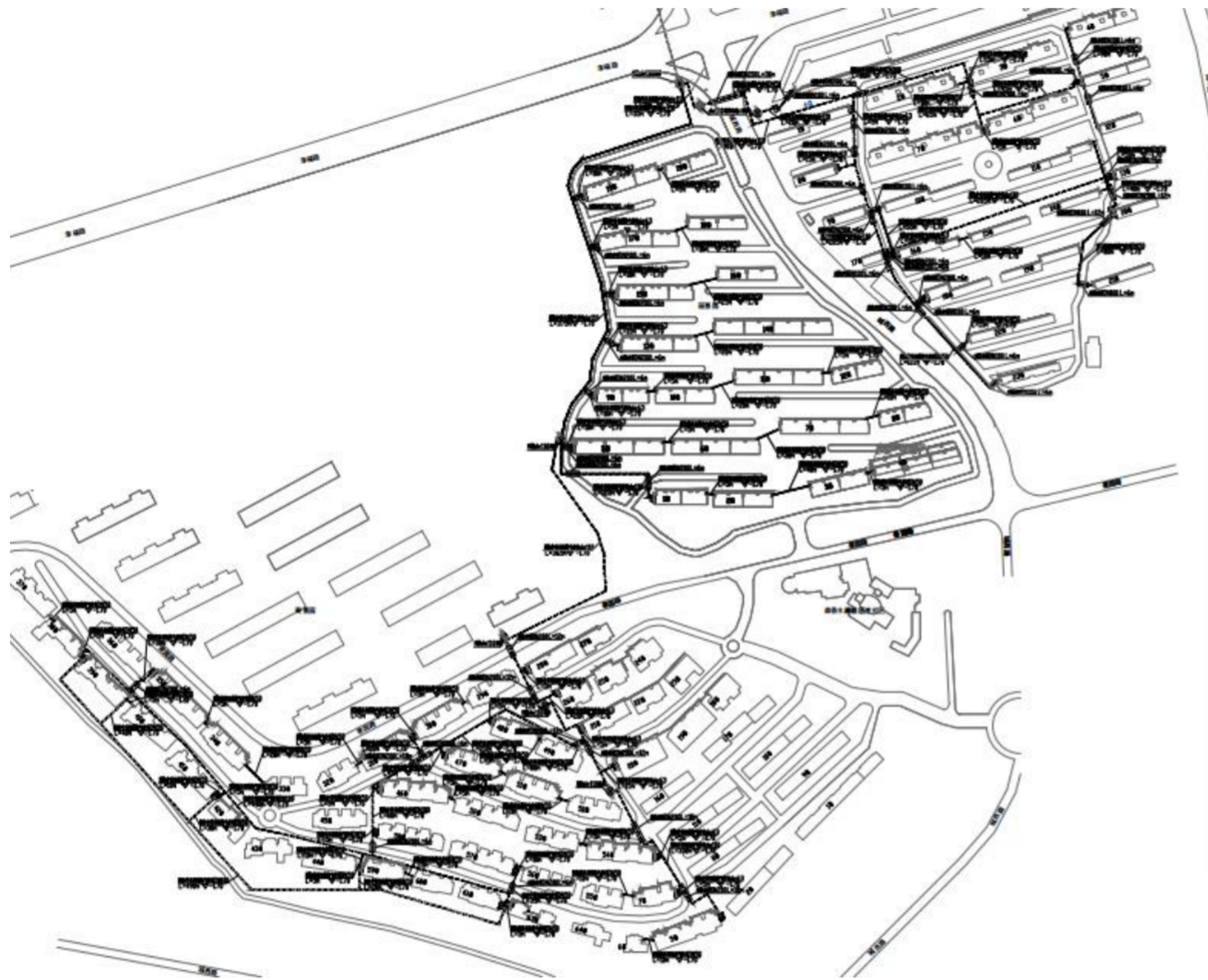
图 4.1.2.4-1 森香水岸小区中压埋地管网图
