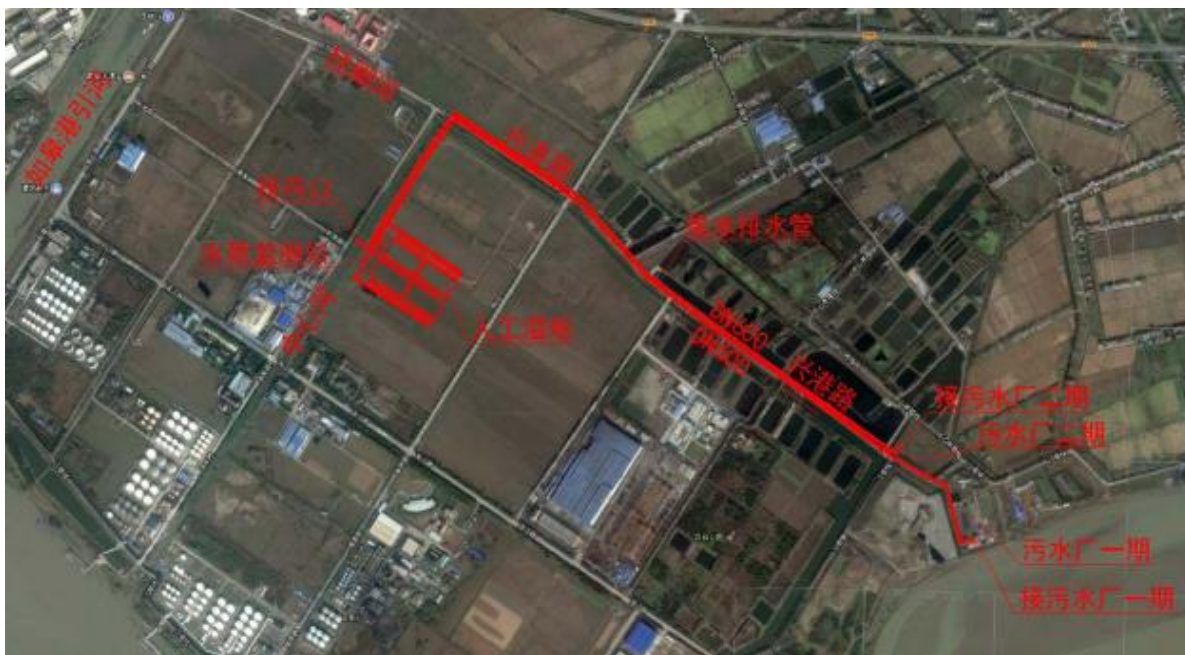
图 2.4.5-1 污水厂尾水排放走向平面图
