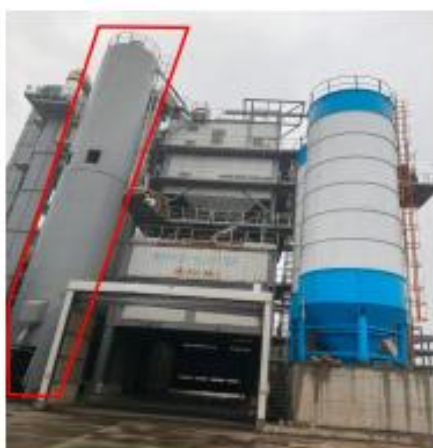
新增的 1 个袋式除尘器除灰尘筒仓
