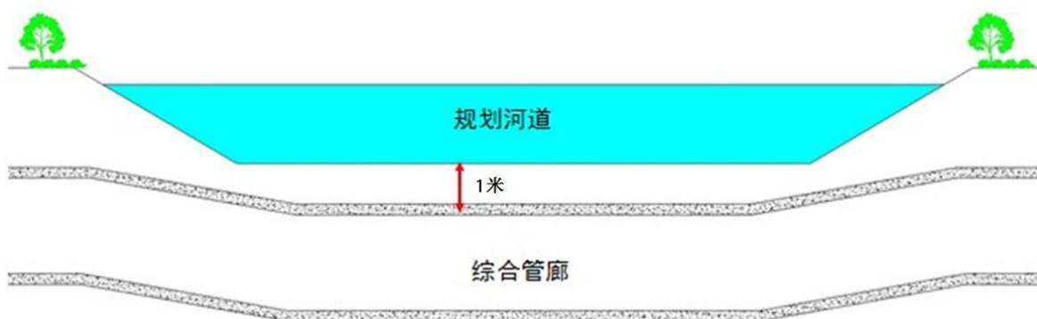
图 2.1-18 管廊穿越河道示意图
