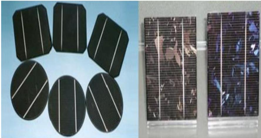
单晶硅硅片、多晶硅硅片图
