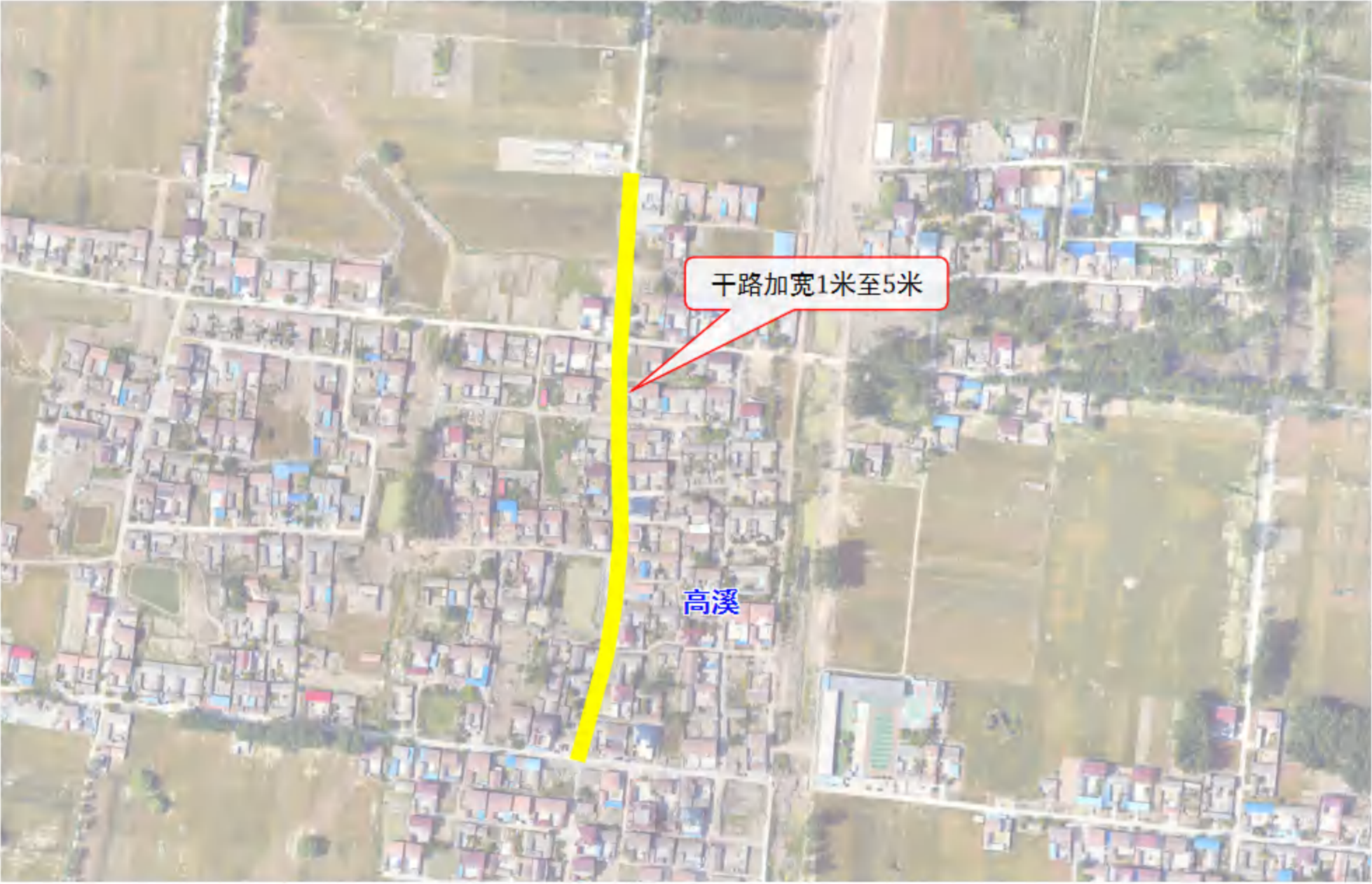
现状村干道水泥路面宽度不足
