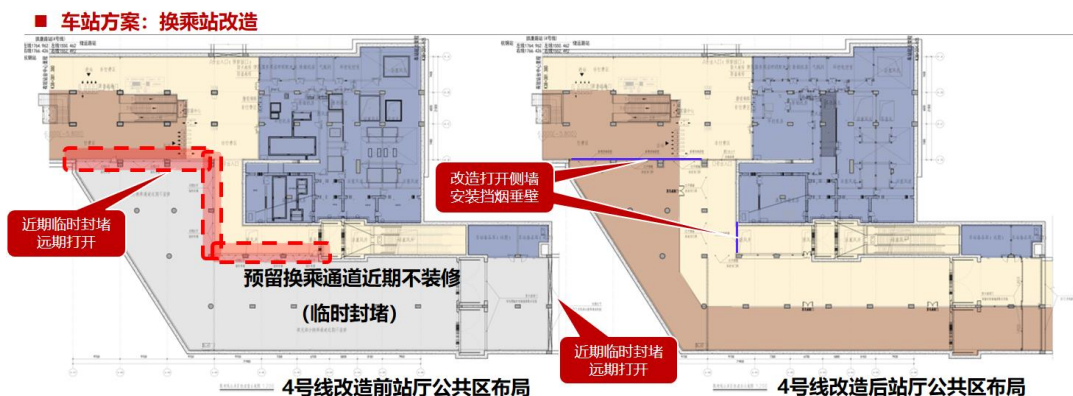
图1.2-3. 换乘通道改造示意图2
