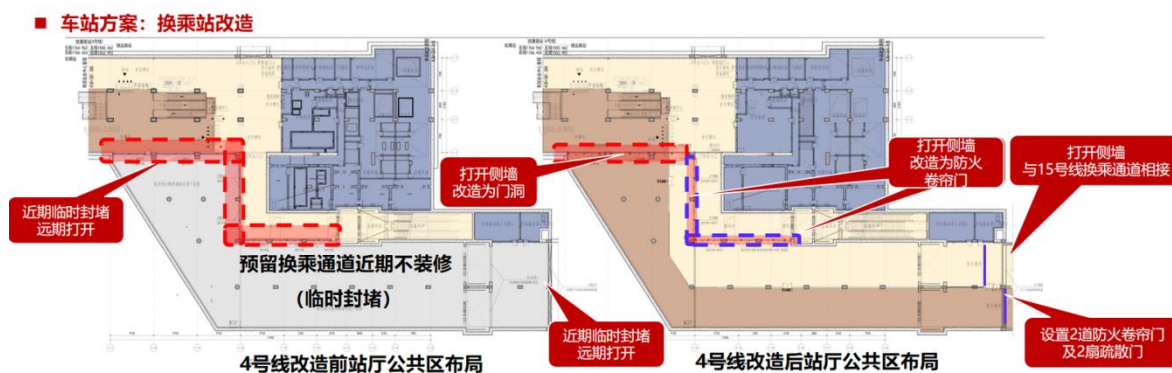
图 4.2-1 换乘通道土建示意图
