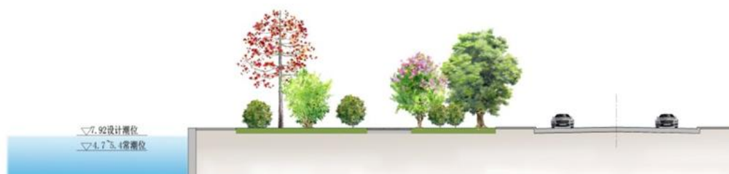
图 6.5-8 直立式堤防断面示意
