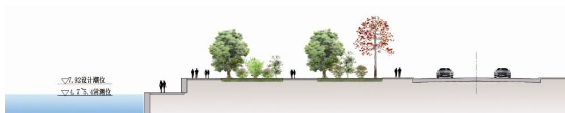
图 6.5-9 复合式堤防断面示意
