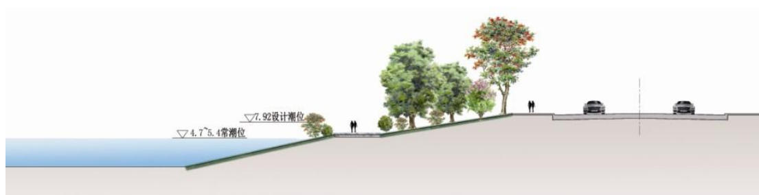
图 6.5-10 多级斜坡式堤防断面示意
