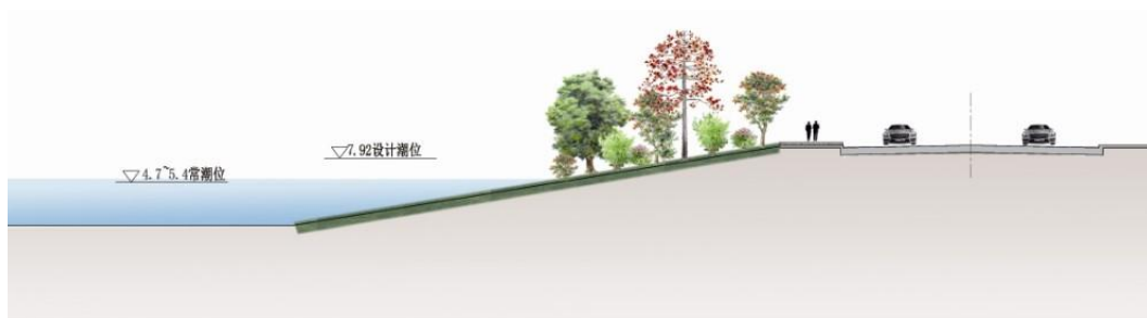
图 6.5-7 斜坡式堤防断面示意
