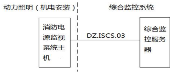
图 3 动力照明与综合监控设备的控制接口二
