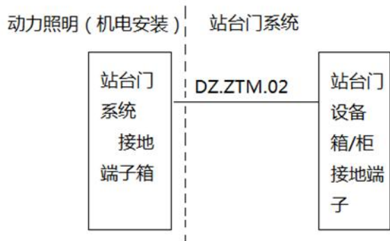
图 1 动力照明与站台门系统设备电源的接口
