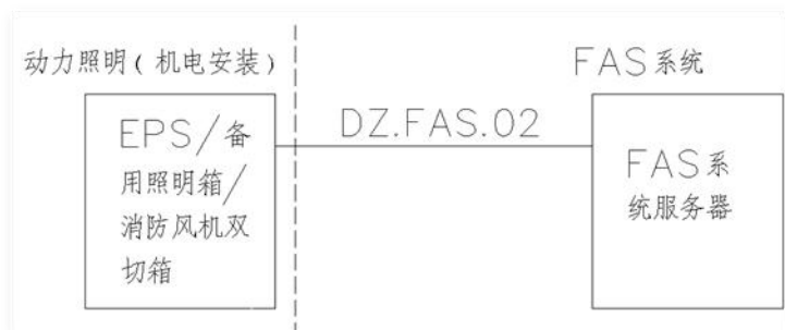
图 2 动力照明与 FAS 设备的控制接口一
