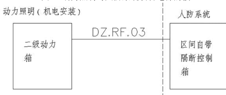
图 3 动力照明与人防系统设备电源的接口三
