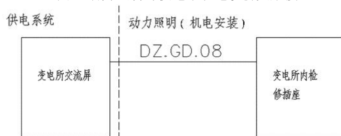
图8 动力照明与供电系统设备电源接口
