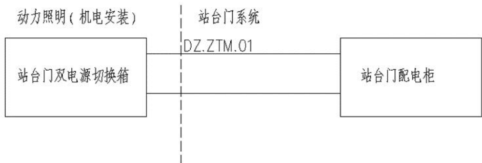
图 1 动力照明与站台门系统设备电源的接口
