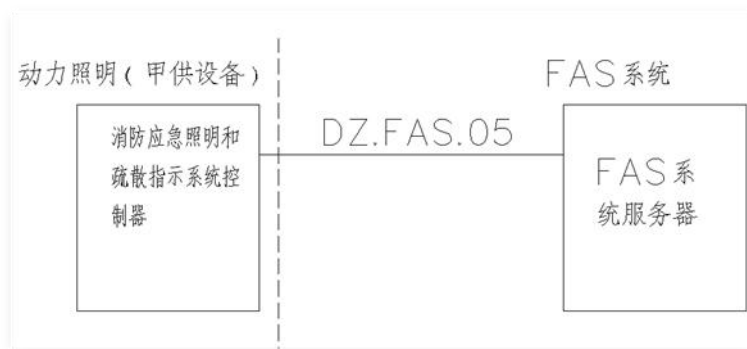
图 5 动力照明与 FAS 设备的控制接口三
