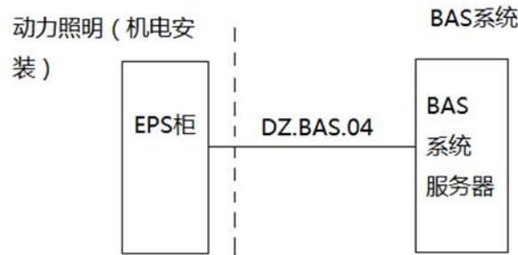
图 4 动力照明与 BAS 设备的控制接口
