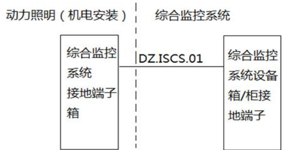
图 1 动力照明与综合监控设备的接地接口
