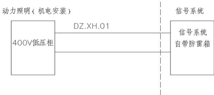
图 1 动力照明与信号系统设备电源的接口
