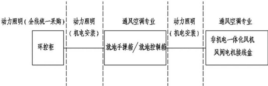
图1 动力照明与通风空调设备电源的接口一
