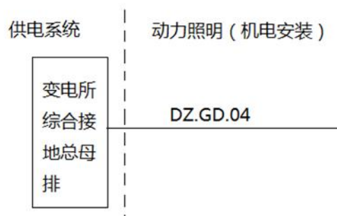
图 4 动力照明与供电系统接地电缆的接口
