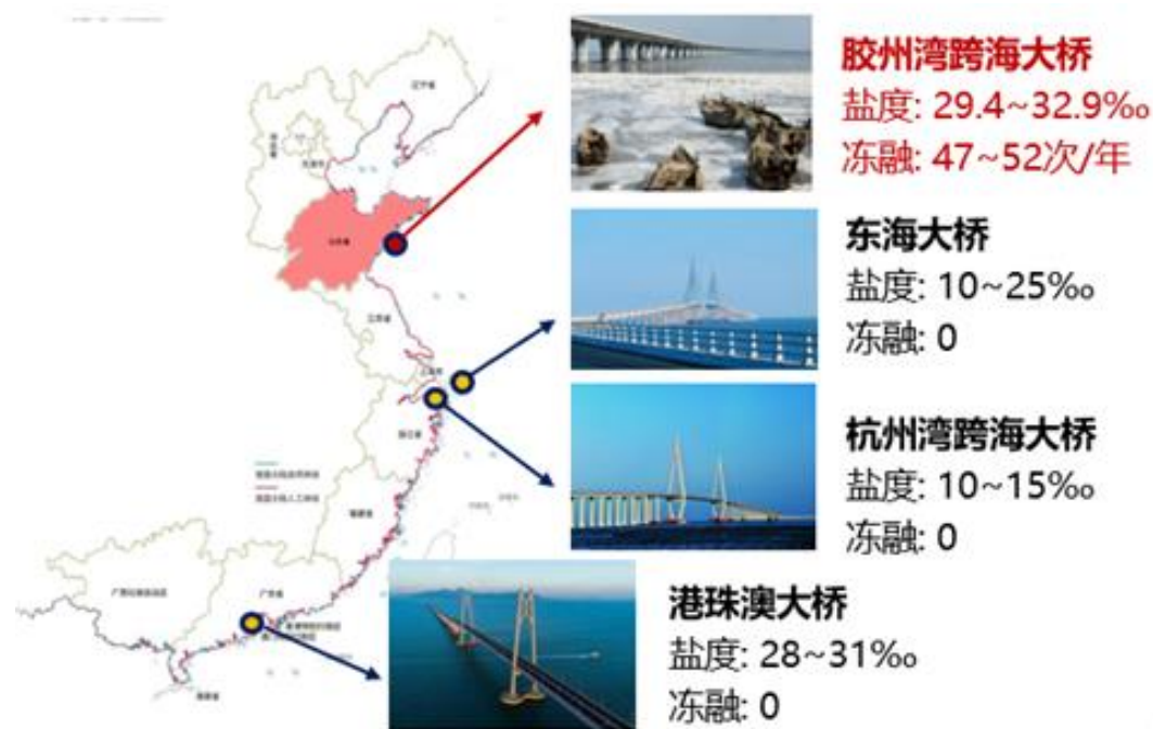
图 1-1 北方冰冻海域桥梁恶劣服役环境
