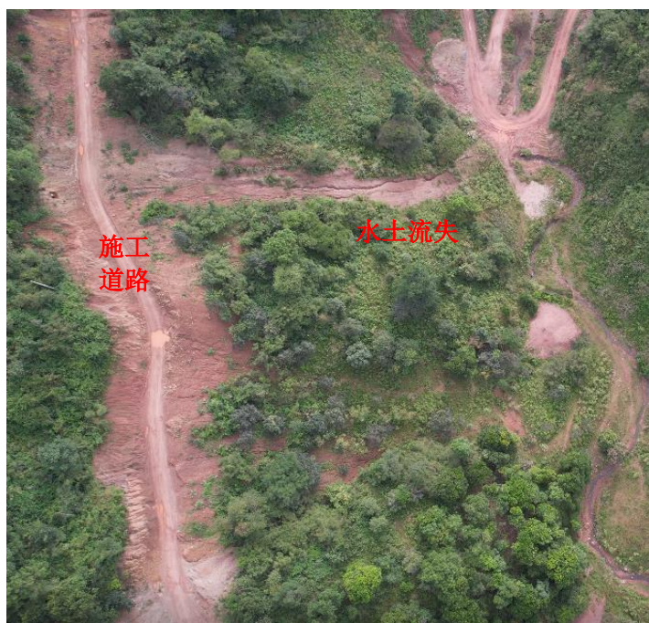
图 2.3.12-1 施工道路建设导致水土流失现象
