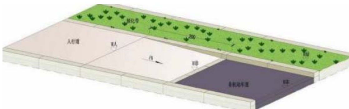
单面坡式残疾人坡道轴侧图
