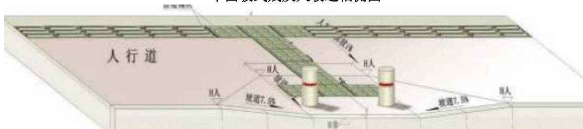
三面坡式残疾人坡道轴侧图
