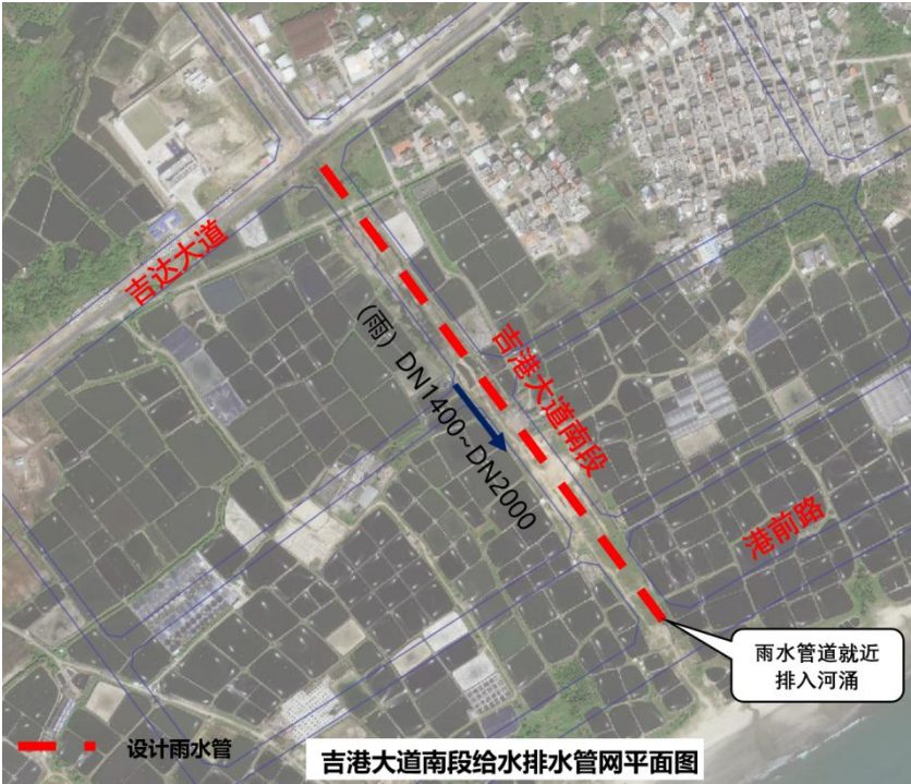
图 5-25 吉港大道南段雨水管网管道布置图
